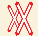
doppia croce di S. Andrea installata verticalmente
