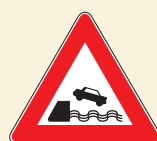
sbocco su molo o argine
