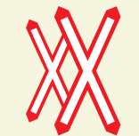
doppia croce di S. Andrea installata verticalmente
