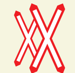
doppia croce di S. Andrea installata verticalmente
